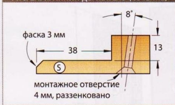
РИС. 2А. КРАЙНИЙ ДЕРЖАТЕЛЬ (СЕЧЕНИЕ)
