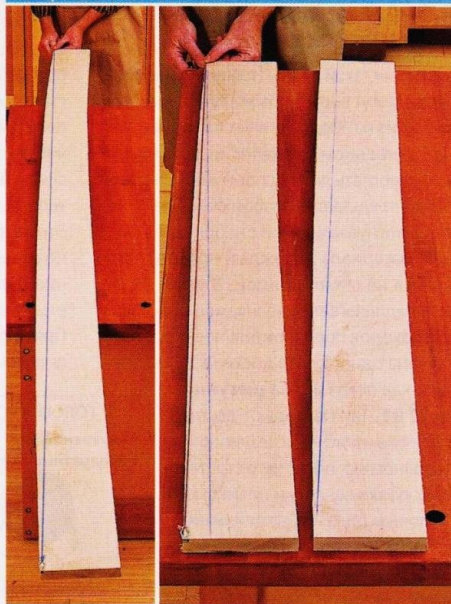
Прижмите вогнутую кромку к направляющей и измерьте максимальную величину прогиба, чтобы найти линию, по которой будет делаться распил.
