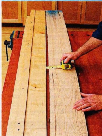
Прижмите вогнутую кромку к направляющей и измерьте максимальную величину прогиба, чтобы найти линию, по которой будет делаться распил.
