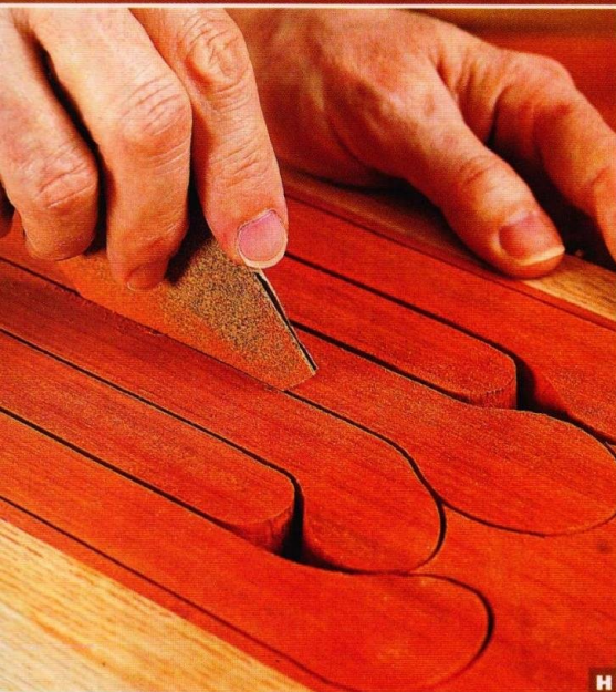
Сложите кусок наждачной бумаги пополам и отшлифуйте пропилы и просветы между язычками, последовательно уменьшая размер абразивных зерен.
