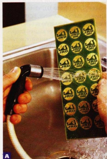
А После экспонирования смойте все остатки незаэкспонированной эмульсии. Если требуется, используйте мягкую кисть, но будьте осторожны, чтобы не повредить затвердевшие участки.
