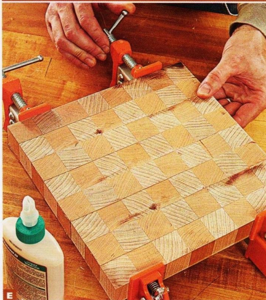
Е Постепенно затягивая струбины, ощупывайте пальцами стыки и выравнивайте полосы в единую плоскость, чтобы доска получилась ровной.
